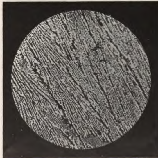
Fig. 145. Weißes Roheisen. Cementit (hell), Sorbit (dunkel).
